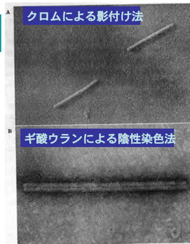
TMV粒子の 電子顕微鏡写真
